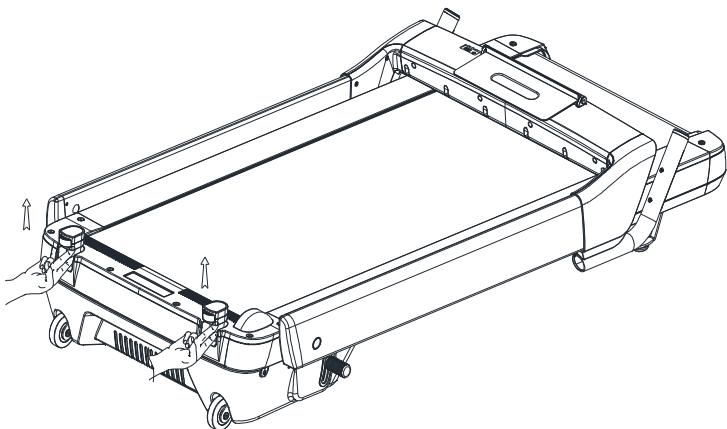
4. Prima di spostare il tapis roulant, estrarre le ruote per la movimentazione secondo il disegno, per assicurare la stabilità verticale della staffa.
