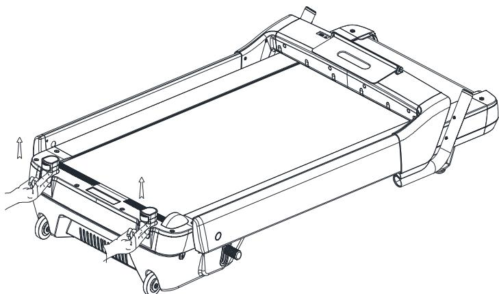
4. Avant de déplacer le tapis de course, extrayez les roues support mobiles, conformément au plan, afin de garantir la stabilité debout de la console.
