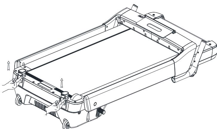
4. Bevor das Laufband bewegt wird, die beweglichen Stützräder gemäß Zeichnung herausziehen, um die Standsicherheit der Halterung sicherzustellen.
