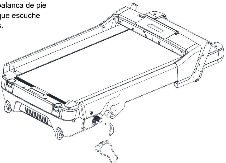
4. Pliegue el soporte protector. Tire del soporte protector hacia la derecha conforme se indica en la figura. Gire hacia abajo para finalizar.
