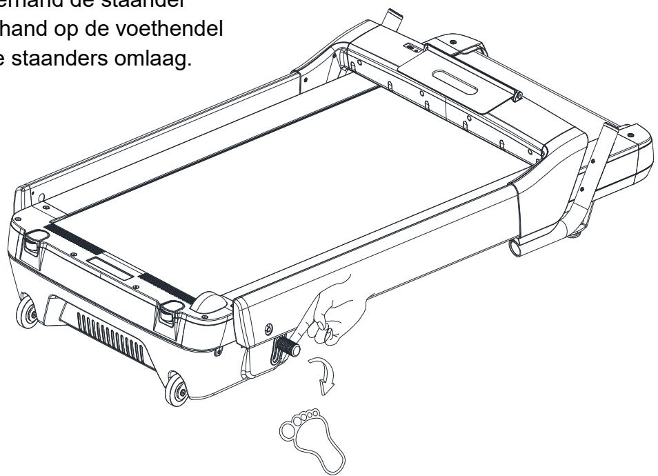
3. Klap de paneelbeugel in. Trek de paneelbeugel naar rechts volgens de richting van de pijl in de tekening. Draai deze vervolgens omlaag. U moet de handgrepen verwijderen wanneer u het product inklapt.
