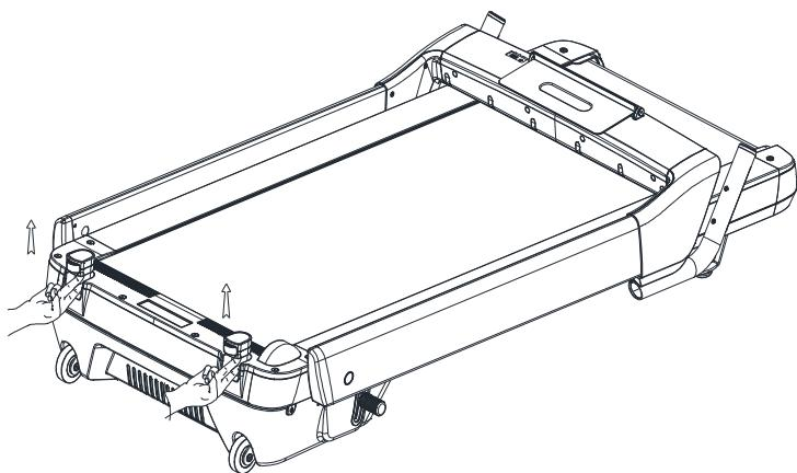
4. Antes de mover la cinta caminadora, extraiga las ruedas de desplazamiento y apoyo conforme se indica en la figura a fin de garantizar la estabilidad del soporte.
